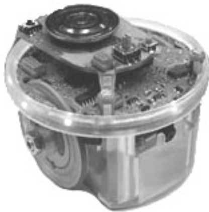
Fig 2.3: Un robot e-puck , realizzato dall'Ecole Polytechnique Fédérale de Lausanne. Questo semplice modello di robot verrà utilizzato nella simulazione descritta nel capitolo 5.
